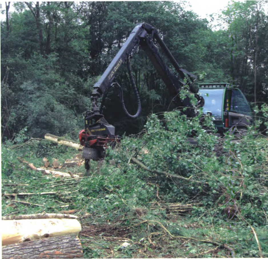
De Harvester ontdoet een boomstam van zijtakken.
