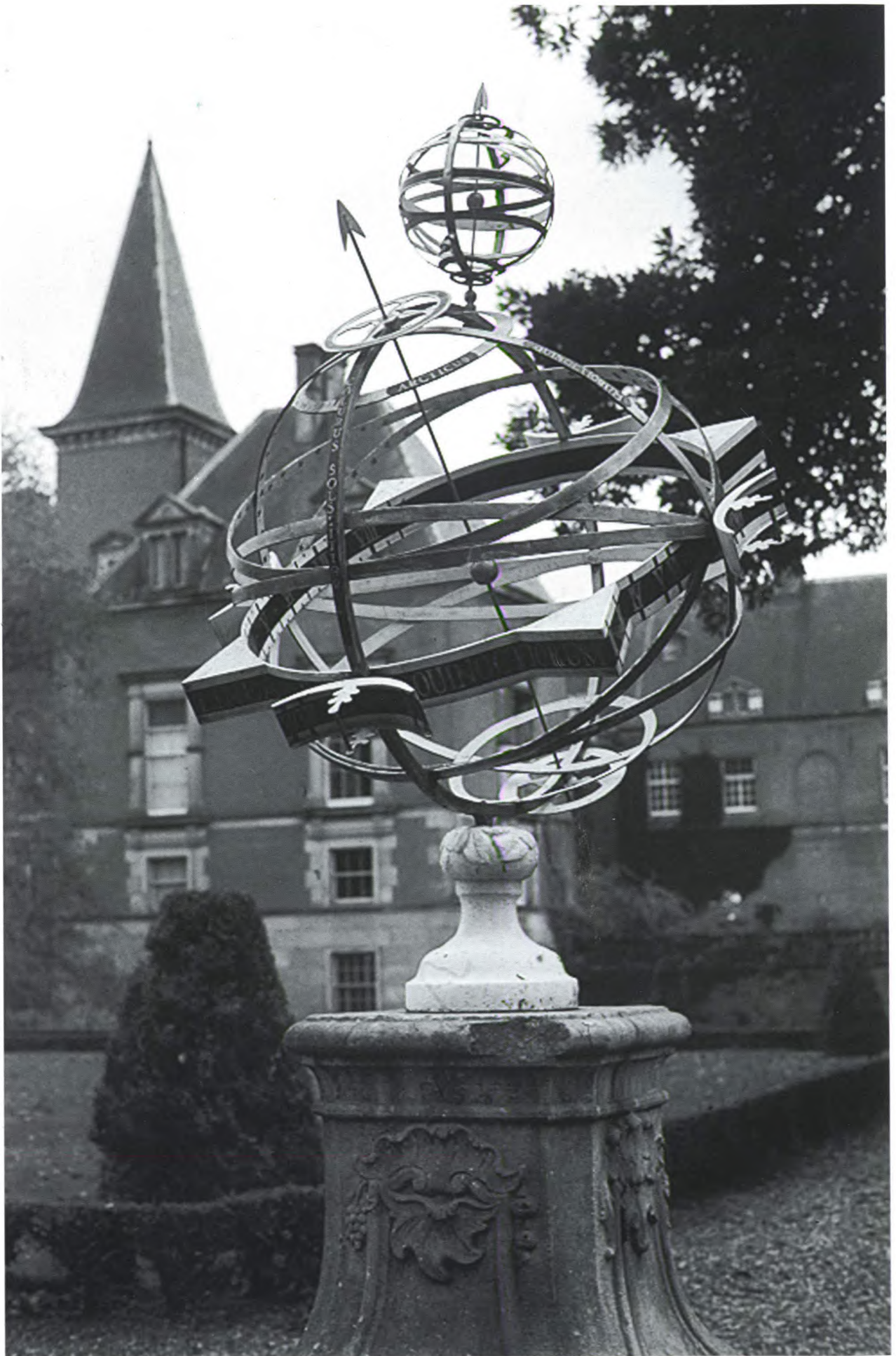
Ook in het nieuwe jaar wijst de zonnwijzer alleen de heldere uren aan. Dit exemplaar is een armillosfeer, een ringzonnwijzer. De uurbecijfering staat langs de binnenkant van de equatorband. Ook de kleine armillosfeer is een zonnwijzer. Fotocollectie Huisarchief Twickel
